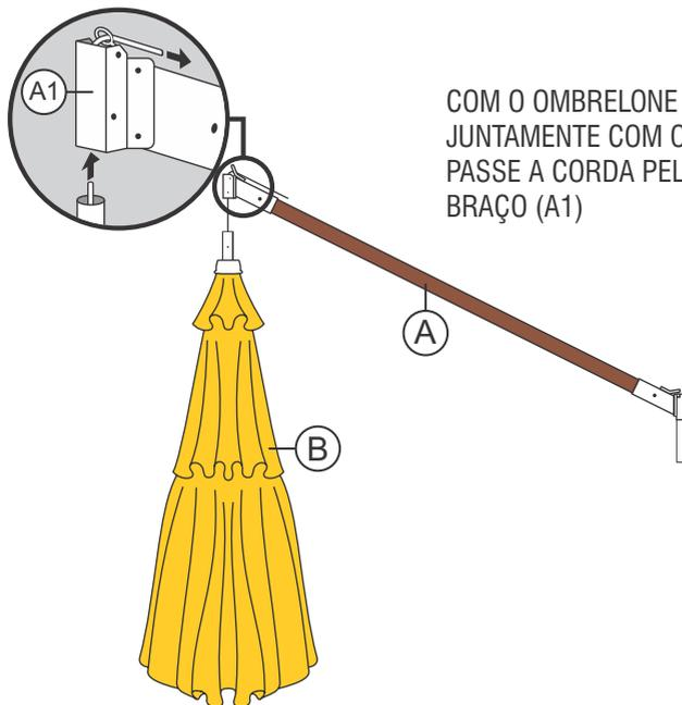
COM O OMBRELONE (B) **DEITADO NO CHÃO**, JUNTAMENTE COM O BRAÇO (A) NA MESMA POSIÇÃO, PASSE A CORDA PELO PASSADOR NO CABEÇOTE DO BRAÇO (A1)
