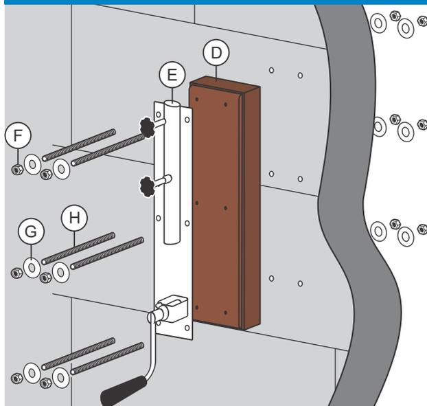
COM A PAREDE PREVIAMENTE PERFURADA, POSICIONE O CONJUNTO MANIVELA (E) COM A BASE MANIVELA (D) NA PAREDE E PASSE AS BARRAS ROSCADAS (H) PREVIAMENTE CORTADAS DE ACORDO COM A LARGURA DE PAREDE, COLOQUE AS ARRUELAS (G) E FIXE COM AS PORCAS AUTO TRAVANTES (F) UTILIZE CHAVE DE BOCA 14mm PARA FIXAÇÃO EM AMBOS OS LADOS.
