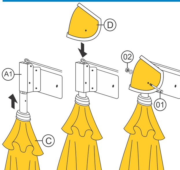
MANTENDO OMBRELONE (B) **DEITADO NO CHÃO**, O APROXIME ATÉ ENCAIXAR NO CABEÇOTE DO BRAÇO (A1), O CHAPÉU © DEVE SER POSICIONADO PARA COLOCAÇÃO DO PARAFUSO 1/4 x 2" (01) COM A PORCA E ARRUELA (02), UTILIZE CHAVE DE BOCA 11mm. PARA FIXAÇÃO.
