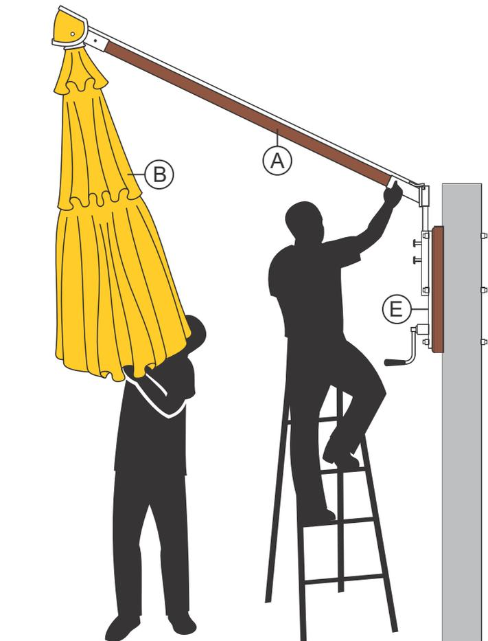
COM O APOIO DE DUAS PESSOAS, UMA PESSOA NO BRAÇO (A) E OUTRA PESSOA NO OMBRELONE (B) O CONJUNTO DEVE SER CUIDADOSAMENTE ERGUIDO E ACOPLADO NO CONJUNTO MANIVELA (E) PREVIAMENTE INSTALADO NA PAREDE.
