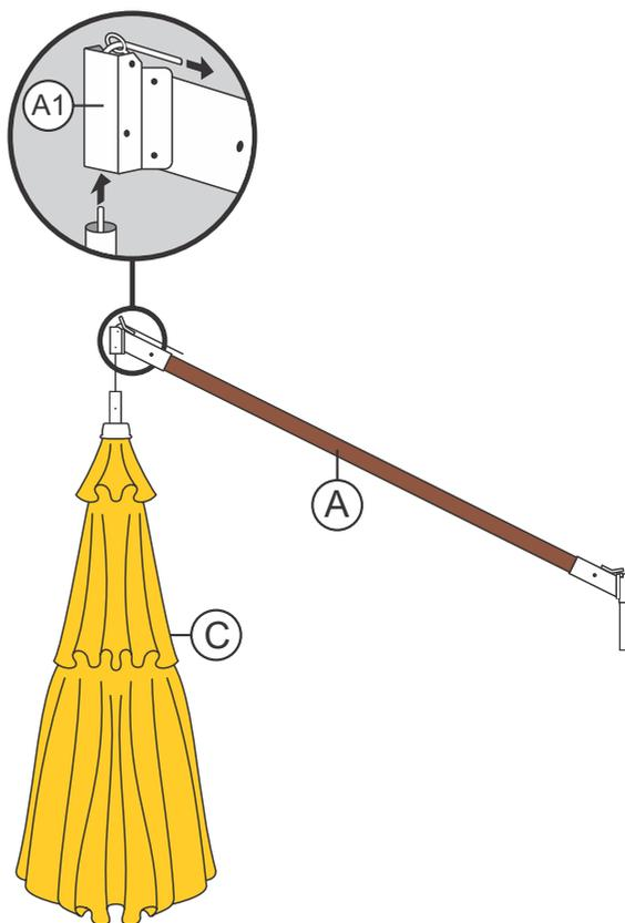
COM O OMBRELONE (C) **DEITADO NO CHÃO**, JUNTAMENTE COM O BRAÇO (A) NA MESMA POSIÇÃO, PASSE A CORDA PELO PASSADOR NO CABEÇOTE DO BRAÇO (A1)
