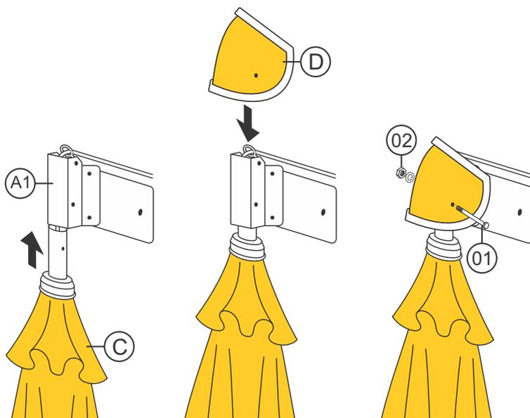
MANTENDO OMBRELONE (C) **DEITADO NO CHÃO**, O APROXIME ATÉ ENCAIXAR NO CABEÇOTE DO BRAÇO (A1), O CHAPÉU (D) DEVE SER POSICIONADO PARA COLOCAÇÃO DO PARAFUSO 1/4 x 2" (01) COM A PORCA E ARRUELA (02), UTILIZE CHAVE DE BOCA 11mm. PARA FIXAÇÃO.
