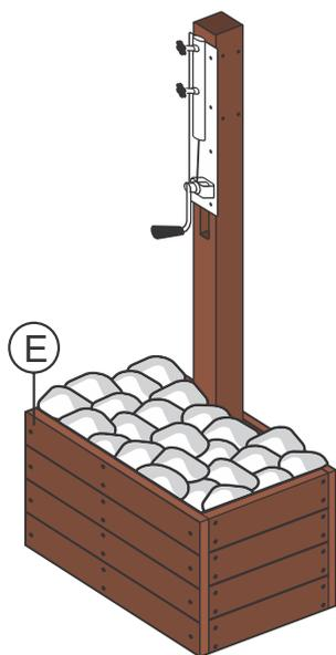
PREENCHA A FLOREIRA (E) COM PEDRAS DECORATIVAS PARA ESTABILIZAR A BASE. MODELO DE **3,00m**. NECESSITA DE **180kg** DE PEDRA. MODELO DE **4,00m**. NECESSITA DE **430kg** DE PEDRA.
