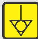
representa o terminal equipotencial usado para o balanceamento dos potenciais do aterramento de proteção entre sistemas e outros equipamentos elétricos.
